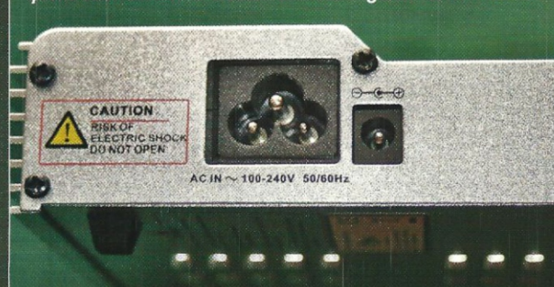
Der Karate B6 kann entweder an einer 10-18 V Gleichstromquelle oder am 230-V-Hausstromnetz angeschlossen werden.
