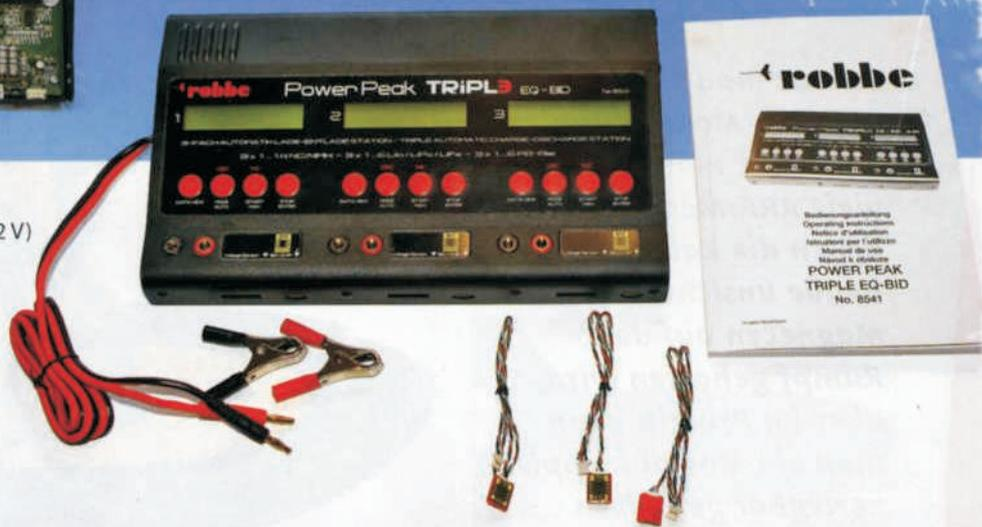
abspeichert. Somit hat man im Gerät für insgesamt 30 Akkus Speichermöglichkeiten, was alleine schon den größten Bedarf abdecken sollte – schließlich könnte man eine Lade-Einheit für NiXX-Akkus verwenden, eine für LiXX und eine für sonstige Akkuvarianten und dabei trotzdem „gechipte“ Akkus, egal welcher Ausführung, wahlweise an jedem beliebigen Ausgang aufladen, ohne extra die Einstellungen penibel prüfen zu müssen.
