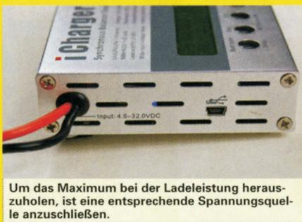
Um das Maximum bei der Ladeleistung herauszuholen, ist eine entsprechende Spannungsquelle anzuschließen.
