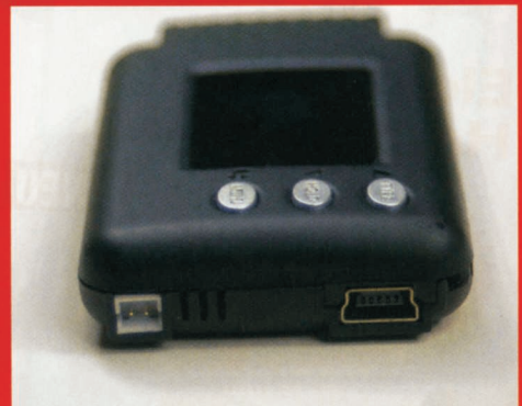
Neben dem USB-Anschluss steht ein weiterer zur Verfügung, an dem beispielsweise ein optischer oder akustischer Alarmgeber angeschlossen werden kann.
