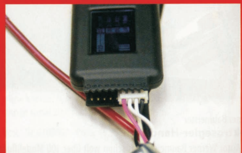
Dank des gängigen Balanceranschluss-Ports lassen sich LiPos zahlreicher Hersteller am CellLog 8S anschließen. Bei Bedarf sind im Handel auch Adapter erhältlich.
