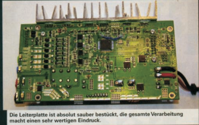
Große passive Kühlflächen erlauben den Einsatz von zwei kleinen leisen Lüftern.
