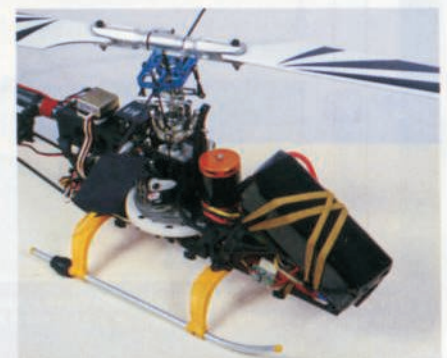
Der 4S 2.000-mAh-Li-Fe-PO4 von Fair im Mini-Titan von Thunder Tiger.
