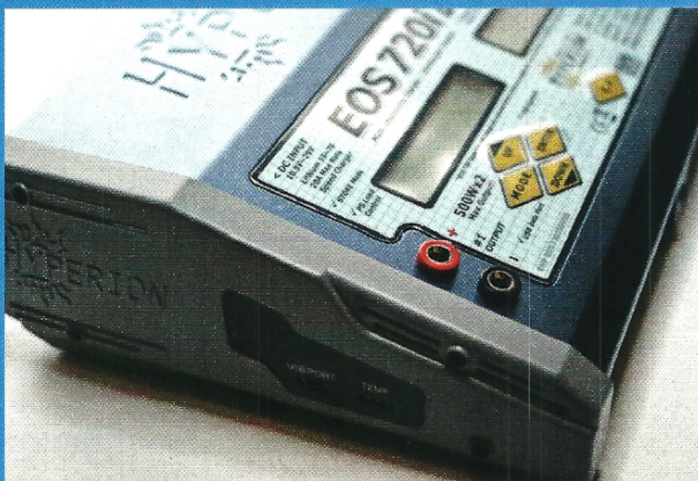
Auf der linken Gehäuseseite befindet sich die USB-Schnittstelle zum PC. Auch ein optionaler Temperatursensor kann hier angesteckt werden.
