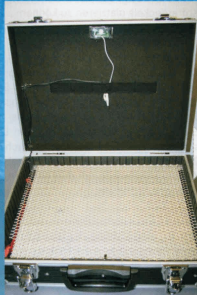
Fertig! So sieht das warme und geschützte Plätzchen für die Akkus aus.
