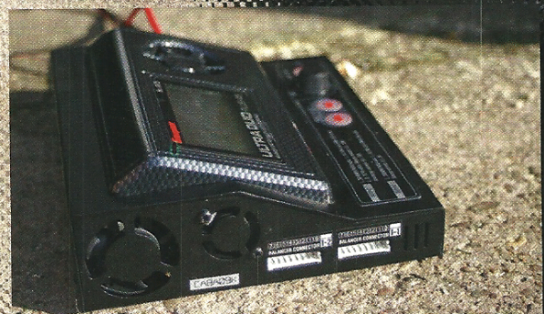
Auf der linken Gehäusesseite befinden sich die Balancer-Anschlüsse für den Ladeausgang 1 (bis 14S LiXX). Auch zwei der insgesamt drei Lüfter haben hier ihren Platz.
