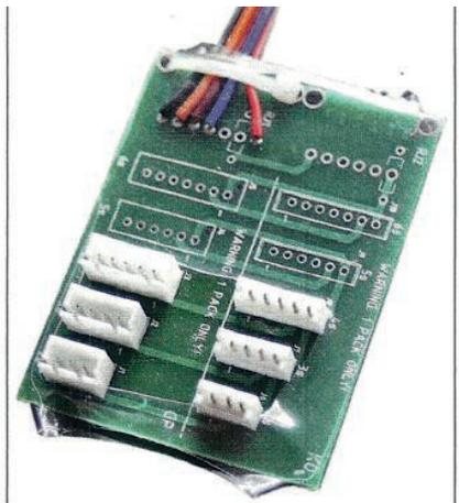
Der Akku wird über den Balancer-Anschluss geladen. Ein Adapter für das EHR- und XH-System liegt bei.
