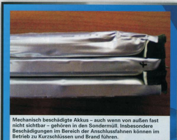
Mechanisch beschädigte Akkus – auch wenn von außen fast nicht sichtbar – gehören in den Sondermüll. Insbesondere Beschädigungen im Bereich der Anschlussfahnen können im Betrieb zu Kurzschlüssen und Brand führen.
