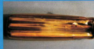
Einige Zellen blähen im Lauf der Zeit auf – der gezeigte Akku hat 160 Zyklen lang arbeiten müssen, die Aufgasung von ca. 7 mm insgesamt ist ein Zeichen der Alterung. Derartige Packs haben zumeist auch einen Kapazitätsverlust von 20% oder mehr.
