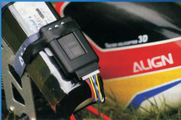
Pfiffiger Helfer: ein Einzelzellen-Logger kann die Spannungen der einzelnen Zellen eines Packs unter Belastung aufzeichnen. Am PC kann man auswerten, ob und welche Zelle(n) unter Belastung besonders „nachgiebig“ sind und die Grenzen der Belastbarkeit setzen.
