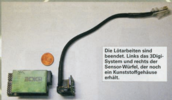
Beim Lötten des Sensor-Würfels wird es wegen der hohen Integrationsdichte schon etwas kniffliger.
